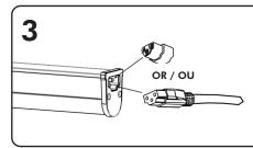
Connect the other side of the flexible wire connector or link connector to the Fluoro Bar light fixture. Raccordez l'autre côté du connecteur de fil flexible ou connecteur au luminaire de barre Fluoro.
